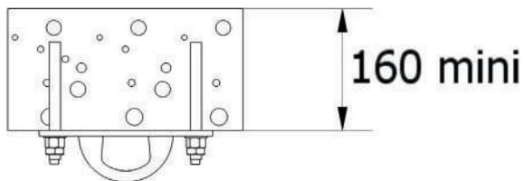
Fijación por anclaje químico M12. Las piezas se pueden fijar también por embridado sobre vigas metálicas o de madera
